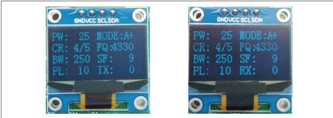
将接收端开发板串口与电脑连接，按下发送端开发板的 KEY4 键（发送键），此时发送端开发板屏幕的右下角“TX:”后的数值递增，该数值代表发送的次数，同时 LED4 闪烁。
